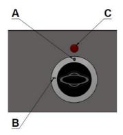
A : OFF positionB : ON positionC : Indicator lamp
